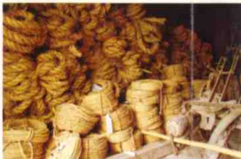
▲水防倉庫(浅井町相模庭) 水防倉庫の中には、木流し用の網・荒縄・土嚢・タコ・カケヤ・スコップ等が常に準備されています。
