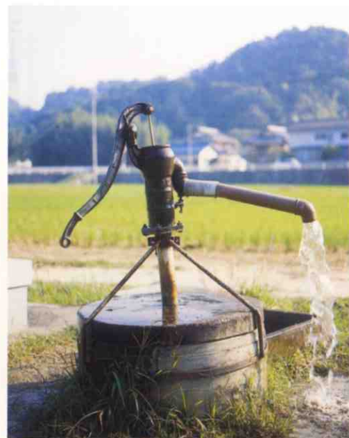
▲ガッチャンポンプ (取っ手の部分を上下させ、地下水を汲み上げる)
