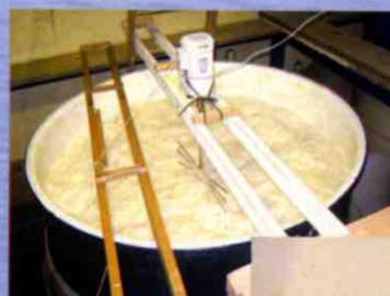
タンクの中で「並行複発酵」が進んでいく。<もろみの仕込み>
